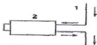
а - однотрубная система, стандартное подключение
