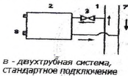
Рис. 1. Цифрами на рисунке обозначены: 1 - падающий стояк, 2 радиатор, 3 - терморегулятор (ручной или автоматический), 4 - вентиль нижний, 5 - воздухоотводчик (ручной или автоматический), 6 - перемычка (байпас), 7 - обратный стояк, 8 - заглушка.
